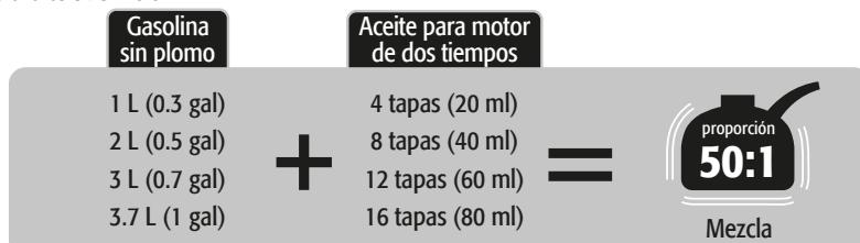
Para alargar la vida útil del motor use aceite sintético TRUPER para motores de dos tiempos.
